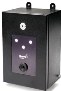
Термокорпус - дополнительная опция к алкотестеру для проходной Динго В-01 или Динго В-02, позволяющая эксплуатировать данные приборы на улице, в условиях пониженной температуры окружающего воздуха. Изделие имеет вандалоустойчивый металлический корпус с запирающейся на ключ дверцей. Представляет собой металлический корпус с внутренним теплоизолирующим слоем и системой нагревательных элементов, автоматически поддерживающей внутреннюю температуру.
